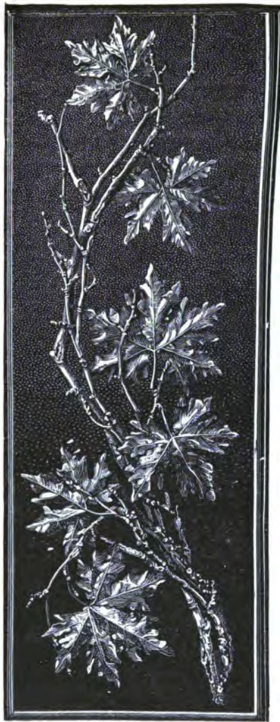
FIG. 63. — Cep de vigne reproduit par la galvanotypie.
